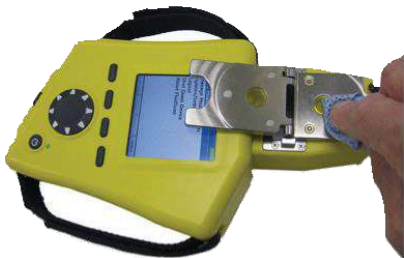
Figure 2: 特許済みフリップトップセルは測定後の洗浄に溶剤を必要とせずクリーニング出来ます。
